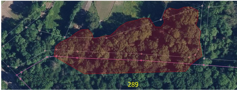
Abb. 106: Digitalisieren des Objekts über die NSG-Grenze hinweg
